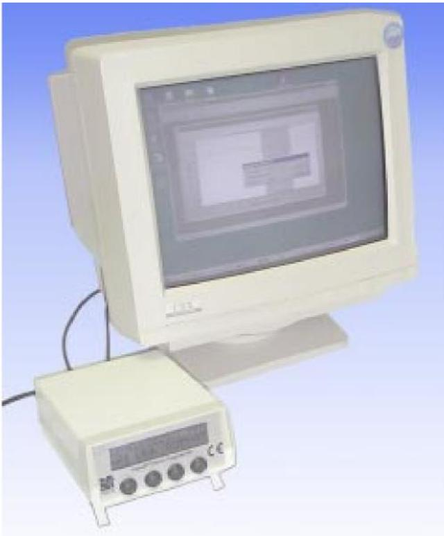
Moniteur Argweld® Titanium purge connecté à un PC grâce au logiciel PurgeLog 2000
