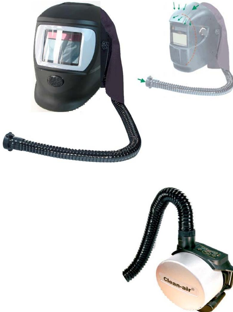
Cette cagoule ventilée permet d'amener de l'air recyclé et filtré, prélevé dans le dos du soudeur (en dehors de la zone polluée) au niveau du visage du soudeur, d'entretenir à ce niveau une légère surpression, empêchant les fumées et les gaz de soudage de pénétrer dans cette zone. La tête du soudeur est "encadrée" au niveau du visage par la cagoule et à l'arrière par un habillement tissu ignifugé, serré autour de la face (trait pointillé).
