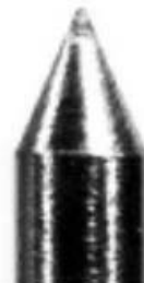
Electrodes tungstène MULTI-STRIKE™ après 20 cordons
