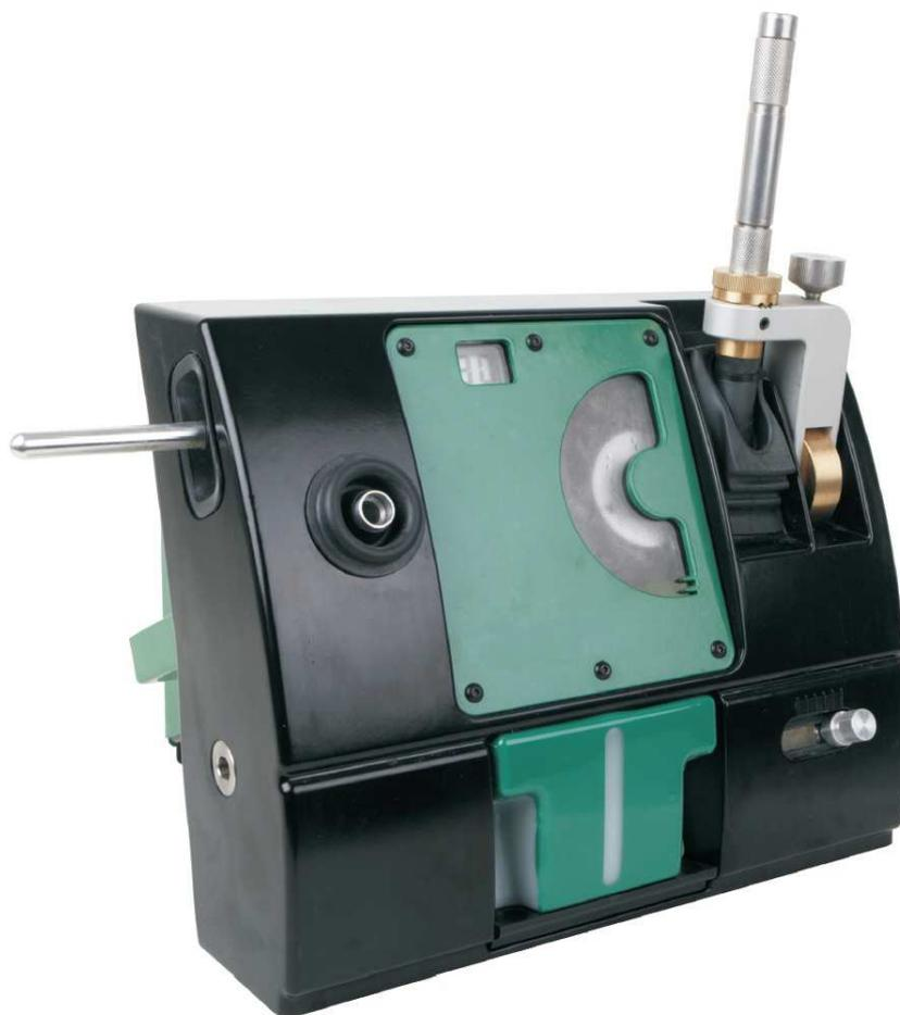
Affûtée dans un liquide de refroidissement combiné avec une vitesse d'affûtage élevée de la meule diamantée, la surface de l'électrode tungstène est égale et brillante (aucun échauffement excessif).
