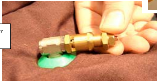
Orifice d'évacuation de l'excès de gaz de purge
