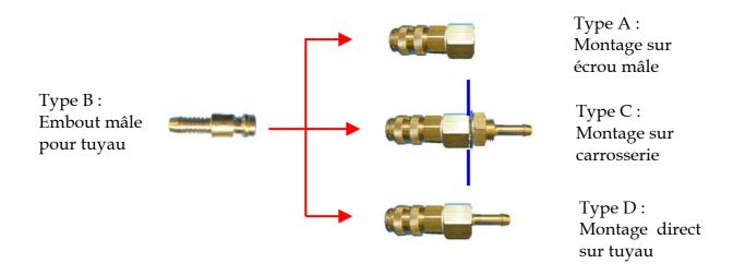
Cette combinaison de raccords rapides (usage : eau ou gaz de protection) de différents diamètres et différentes configurations permet le montage de torches MIG et TIG (la partie femelle est adaptée aux raccords males de la torche), leur raccordement (rallonges) ,..... Obturation automatique au désaccouplement.
