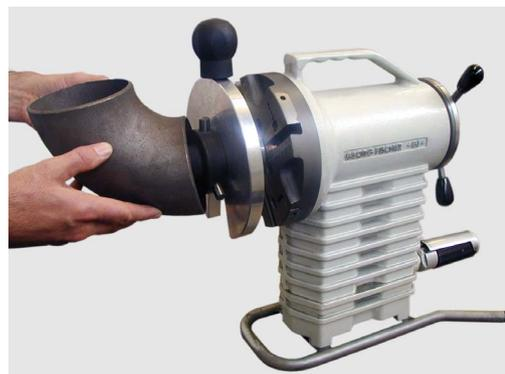
6. Une fois le coude de tube correctement positionné, serrer la broche filetée (4) avec la clé mixte (SW 18).
