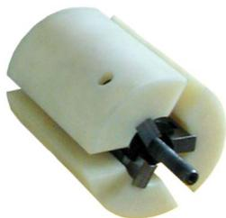
Segments de serrage Delrin spécifiques pour l'usinage de tubes à parois fines par un système de serrage sans déformation.
