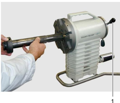
2. Installer l'outil de centrage (2) entre le mât et le support d'outil et le fixer en tournant avec le positionnement d'avance (1) jusqu'au seuil de résistance.
