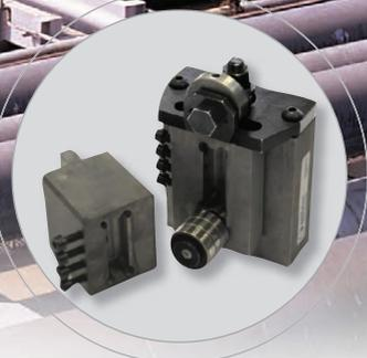
**Module de suivi de profil pour REB 14 et 20.** Le module détecte le diamètre intérieur du tube. La tension du ressort permet de compenser l'ovalisation du tube et d'obtenir ainsi une hauteur de talon constante lors de l'usinage. Le module de suivi de diam. int. permet de préparer tous types de joints de soudure, en V, en Y ou en U. **Code 790 094 013.**
